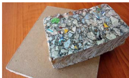
Takto vyzerá recyklovaný TetraPak, zlisovaná tehlička a izolačná doska Zdroje: www.kuruc.sk , www.priateliazeme.sk
