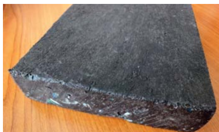
Takto vyzerá recyklovaný TetraPak, zlisovaná tehlička a izolačná doska Zdroje: www.kuruc.sk , www.priateliazeme.sk
